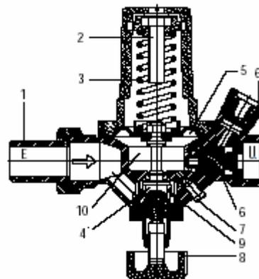
1. Подключение для шланга. 2. Установочный винт.
